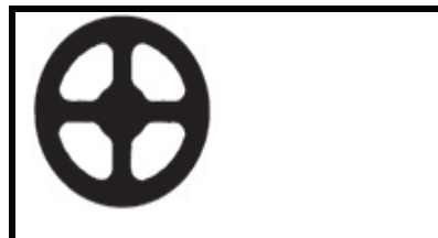
VOLANTE DE ACCIONAMIENTO Ø 165mm CON CUADRADILLO DE F 30 mm x 30 mm
